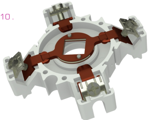
Double bridge Rotor contact Knife type Fixed contacts with self-cleaning effect. Contatto mobile a doppio ponte contatti fissi a coltello con effetto strisciante autopulente.
